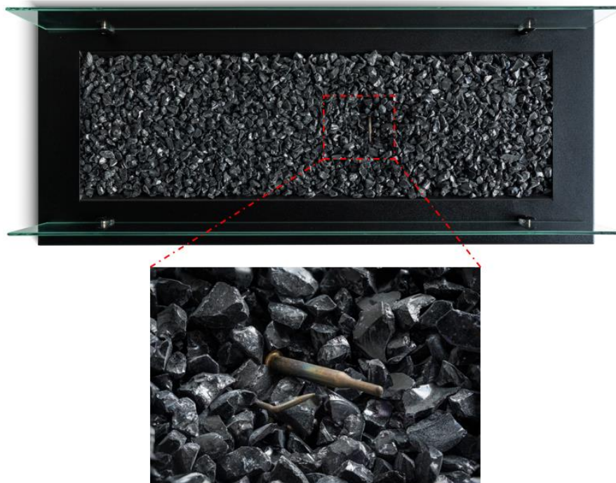
Abbildung 2 – RIO Zündelement und Ansicht von oben
