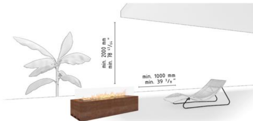
Abbildung 1: Mindestabstand zu brennbaren Materialien
